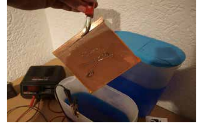
Görsel 10 Elektro Etching yedirme tekniği
